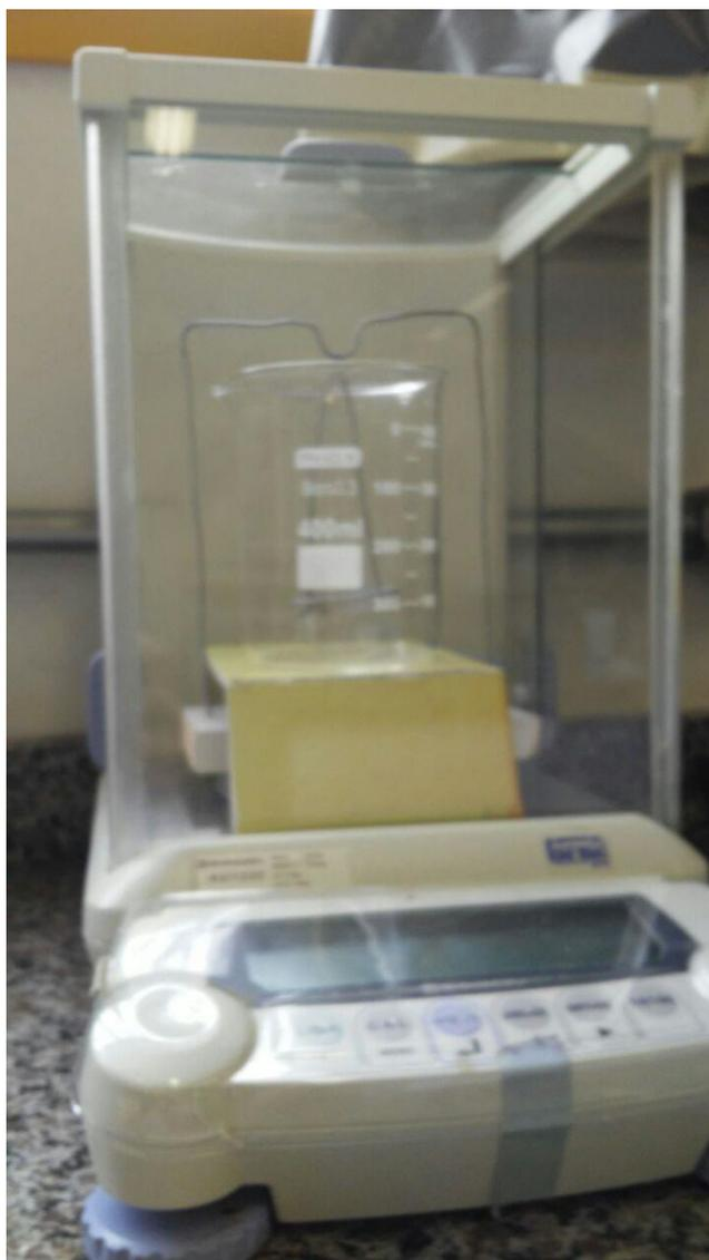
Os corpos de prova eram colocados dentro da peneira, que suspensa em água, permite a medição do material imerso. A parte amarela é utilizada para suspender o béquer com água e não sobrecarregar a carga máxima permitida pela balança de 200g.
