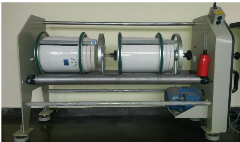
O moinho trabalhou com volume de 20% de bolas de alumina e 30% de volume em amostra, com uma rotação de 36 rpm, sendo feito um acompanhamento de aproximadamente 2horas.
