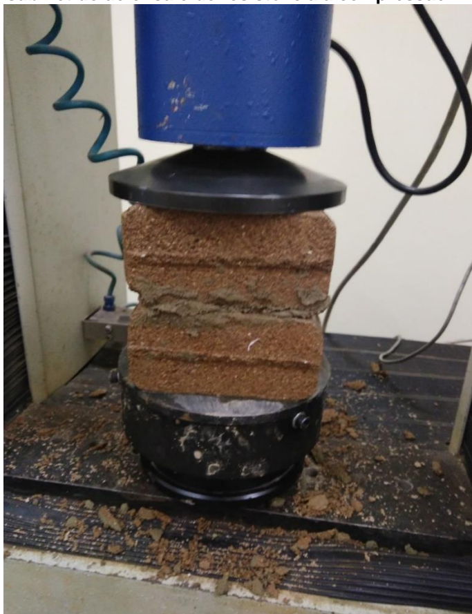
Figura 13 - Ilustração representando o corpo de prova sendo submetido ao ensaio de resistência à compressão
