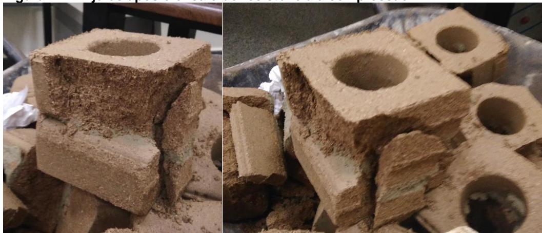
Figura 17 – Tijolos após o ensaio de resistência à compressão
