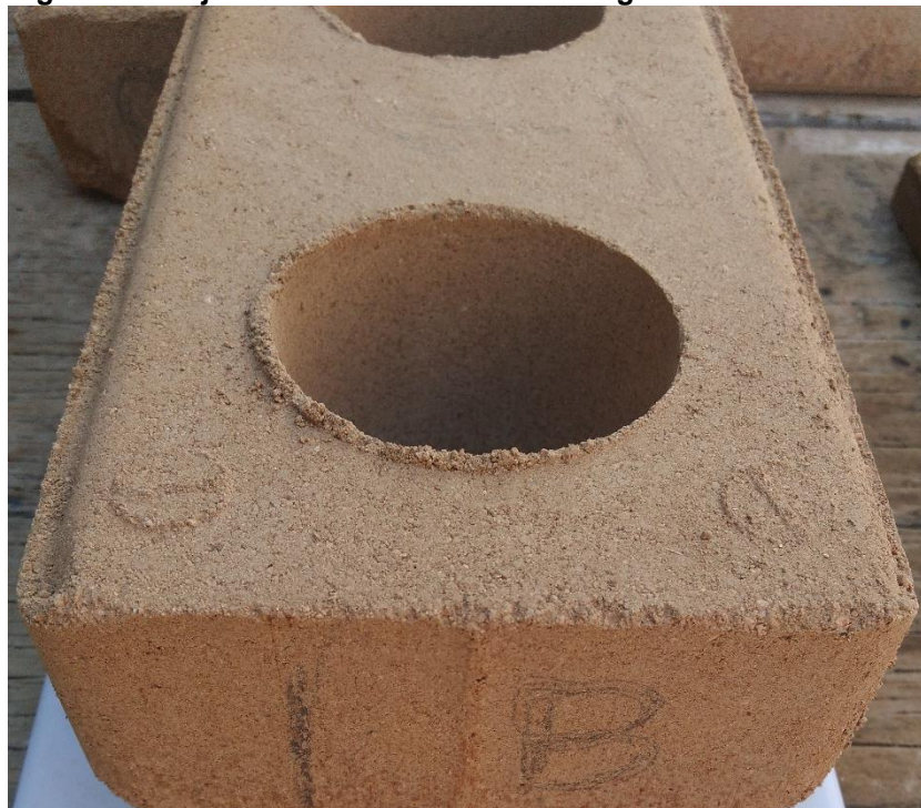
Figura 15 – Tijolo do lote da mistura 1 sem grânulos de lodo visíveis
