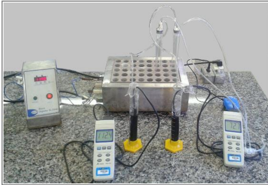
Figura 5: Módulo para determinação da estabilidade oxidativa
