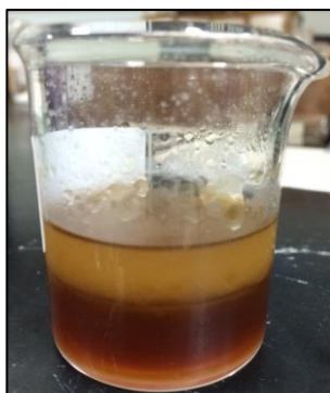
Figura 16 – Separação entre fases na amostra coletada após a reação, na qual o excesso de metanol encontra-se na fase superior
