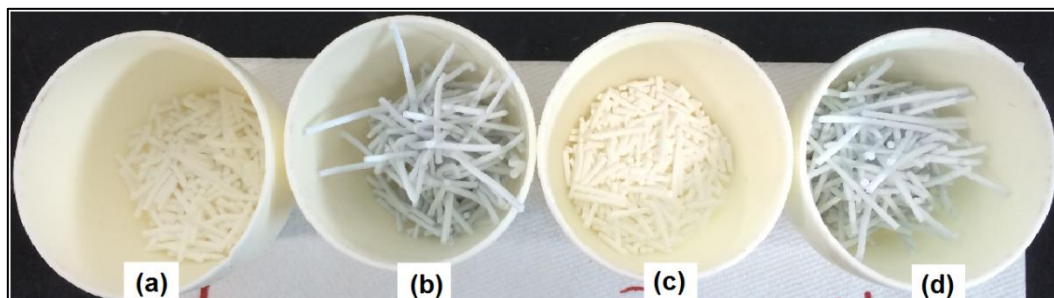
Figura 15 – Catalisadores (a) Z/ZrO 2 , (b) ZN/ZrO 2 , (c) ZS/ZrO 2 e (d) ZSN/ZrO 2 após a calcinação a 450°C
