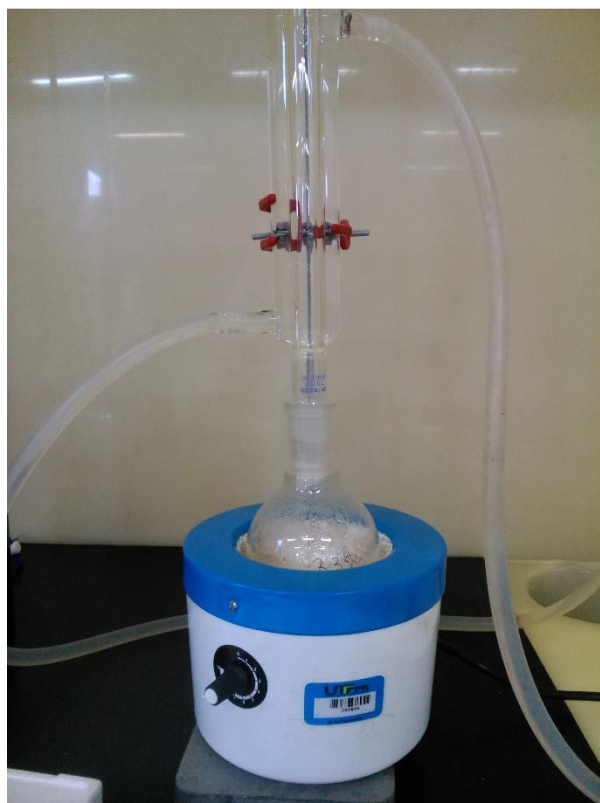
Figura 4 - Sistema de Aquecimento Montado
