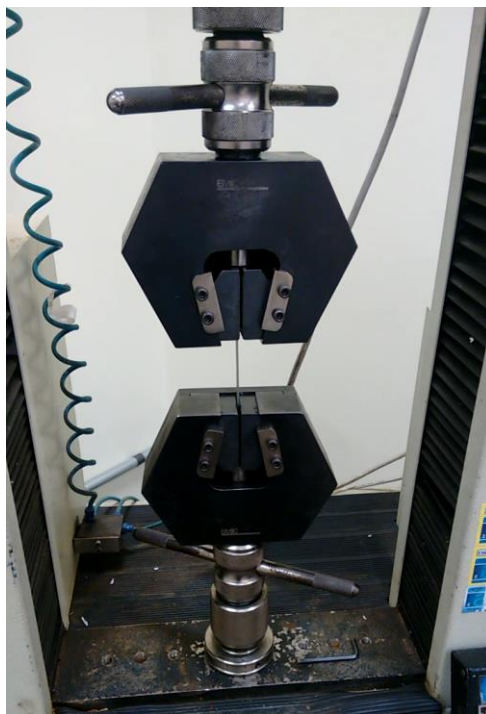
Figura 2- Momento do ensaio de tração das amostras de PET
