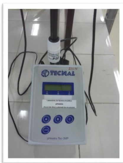
Figura 12: pH digital com eletrodo de escala de bancada Tecnal®. Fonte: Autoria própria (2015)
