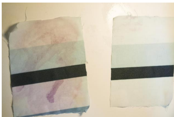
Figura 13. Tecidos com e sem sêmen simulado, respectivamente, após aplicação do reagente
