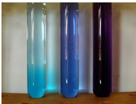
Figura 9. Reagente de Biureto sem reação (à esquerda), e com soluções proteicas (ao centro e à direita)
