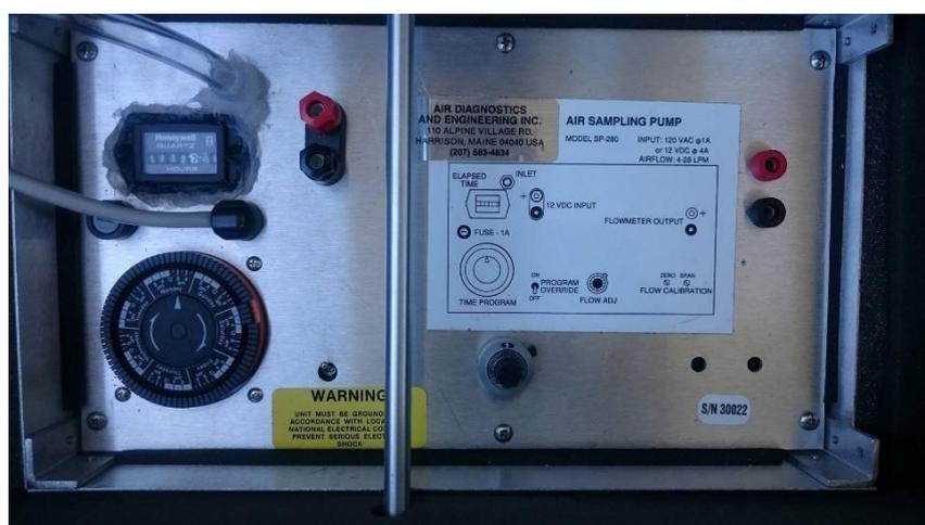
Figura 6 – Bomba à vácuo, utilizada na amostragem.
