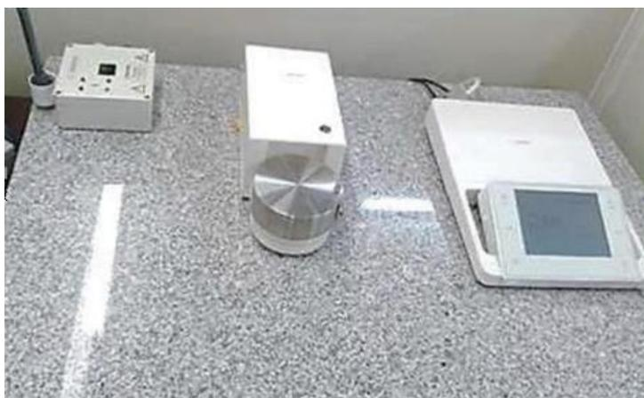
Figura 7 - Microbalança analítica e caneta eliminadora de eletrostática
