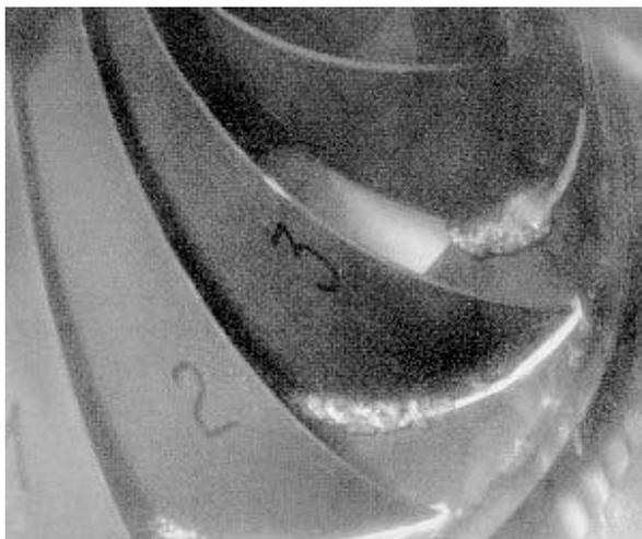
**Figura 7 – Formação da cavitação fixada numa turbina Francis.**
