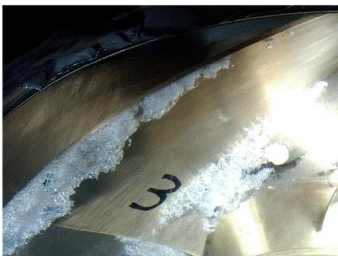
**Figura 17 - Afastamento das bolhas de cavitação.**
