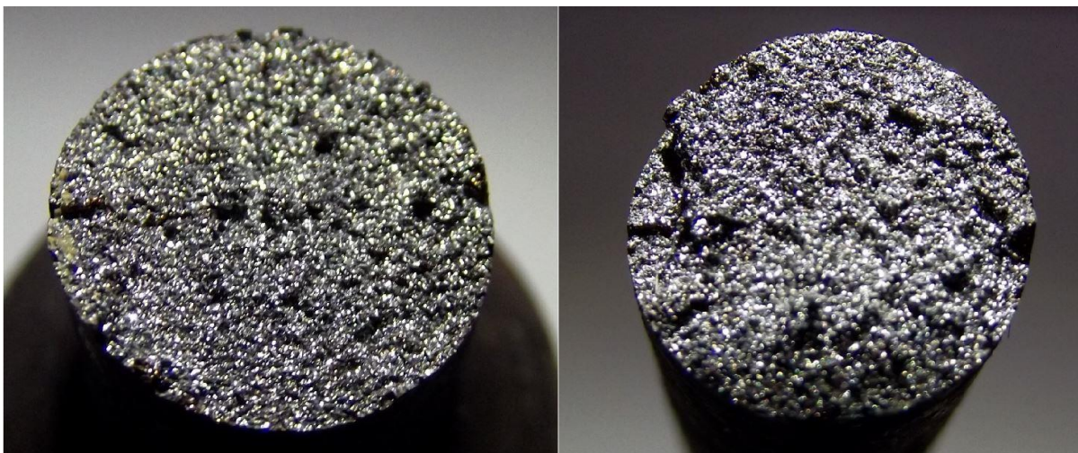
Figura 19 - Região de ruptura para corpo de prova 2 no ensaio de tração para têmpera e revenimento a 250°C Fonte: Autoria Própria
