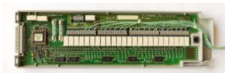
Figura 11 – Slot do sistema de aquisição de dados. Fonte: www.commons.wikimedia.org
