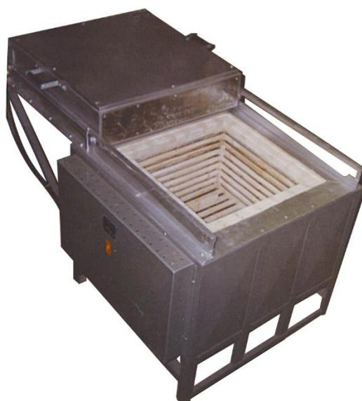
**Figura 4 - Forno industrial elétrico**
