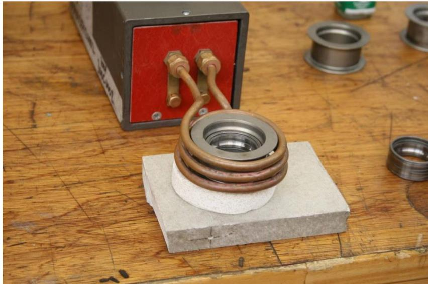
**Figura 5 - Aquecimento por indução eletromagnética**
