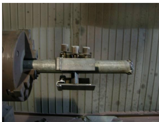
Figura 20 – Modo de deposição das ligas por aspersão térmica: usualmente (a); utilizado (b) Fonte: Autoria Própria
