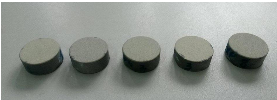
Figura 12 – Amostras utilizadas no ensaio de ultrassom após a deposição dos revestimentos. Fonte: Autoria Própria.
