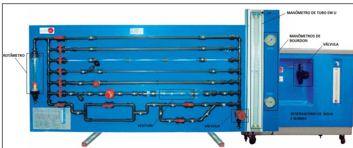
**Figura 15 – Bancada experimental de perda de carga da Edibon.
