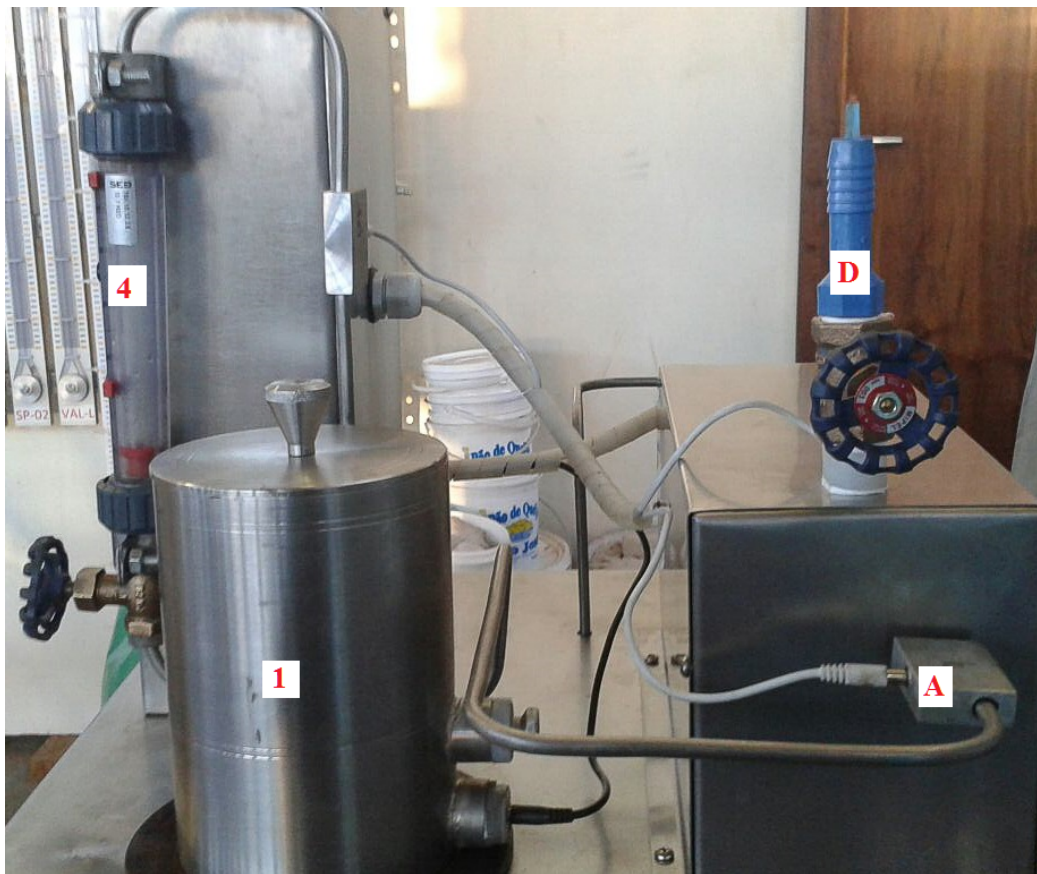
Figura 18 – Vista lateral direita do sistema montado, sendo: 1) Reservatório de nanofluido; 4) Rotâmetro; A) Saída do nanofluido e D) Saída do fluido frio.
