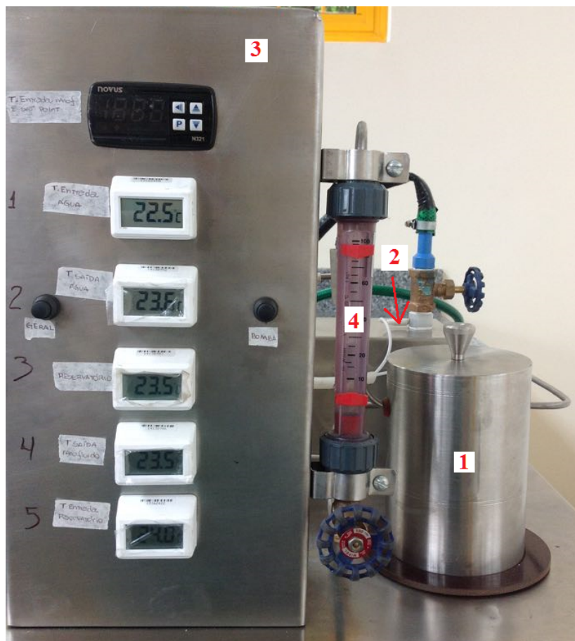
Figura 15 - Sistema montado, sendo: 1) Reservatório de nanofluido; 2) Trocador de calor; 3) Central de controle de temperaturas e 4) Rotâmetro.
