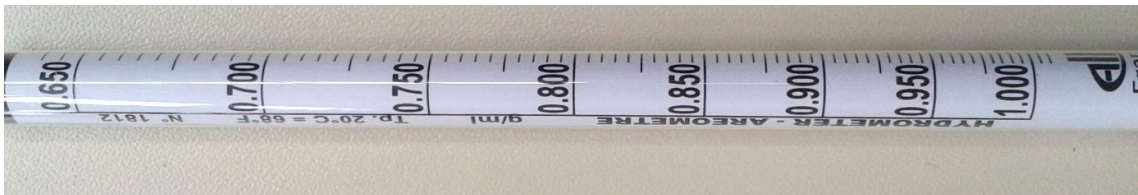
Figura 4 – Graduação do densímetro em g/ml.
