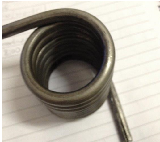
Figura 12- Serpentina do trocador de calor.
