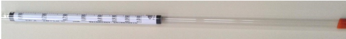
Figura 3 – Densímetro com chumbo em sua base
