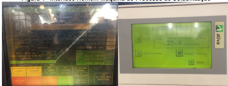
Figura 4 - Interface Homem-Máquina do Processo de Solubilização
