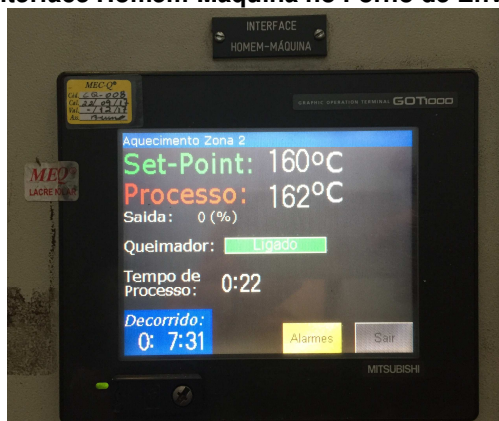
Figura 5 - Interface Homem-Máquina no Forno de Envelhecimento
