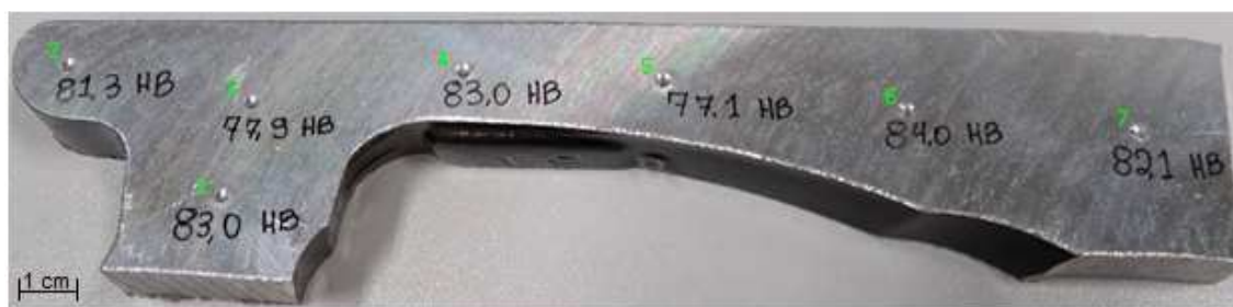
Figura 8 - Perfil de dureza após o Processo de Pintura
