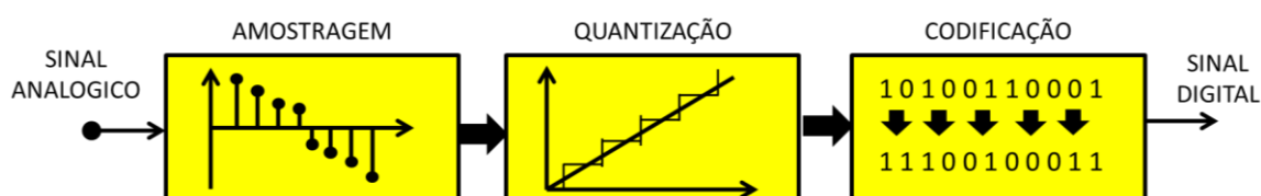
Figura 15 – Processo de conversão analógica – digital
