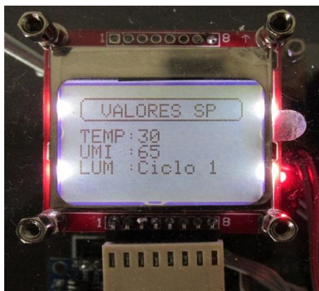
Fotografia 11 – Tela Valores de Set-Point Fonte: Autoria Própria.
