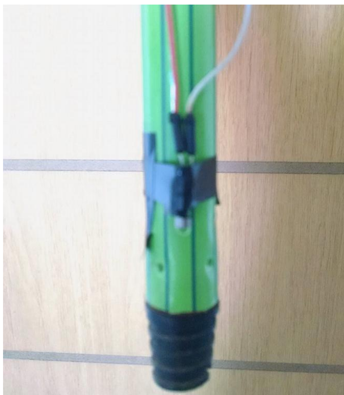
Figura 22 – Motor de vibração acoplado à parte inferior do bastão Fonte: Produção própria
