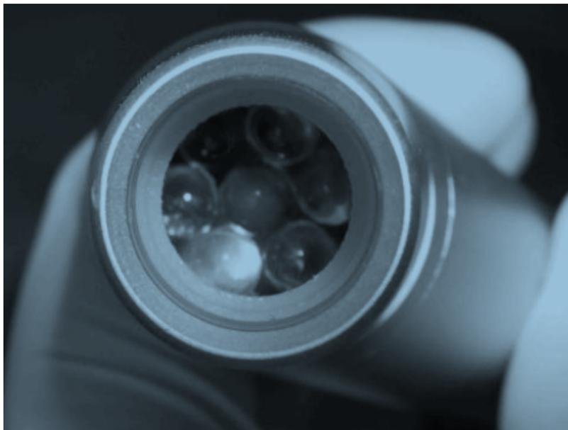
**Figura 21 – Arranjo de LEDs na faixa de 880nm.
