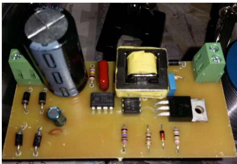
Figura 48 – Conversor *flyback* em placa de circuito impresso.
