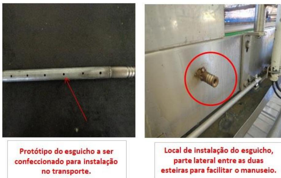
**Figura 10 – Sistema de limpeza dos transportes**
