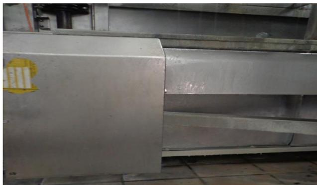
**Figura 18 – Proteção do sistema de transmissão enchedora/recravadora**
