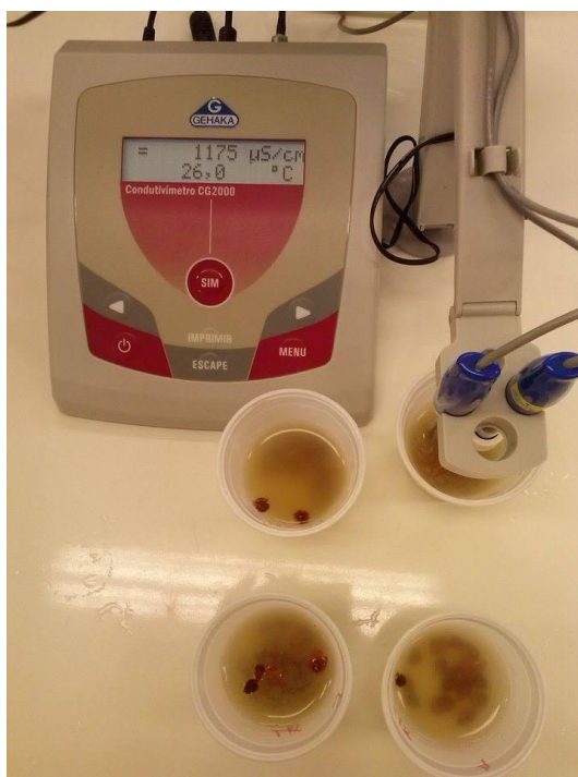
Figura 5- Leitura de condutividade elétrica massal de sementes de Cabralea canjerana . UTFPR Câmpus Pato Branco, 2016.
