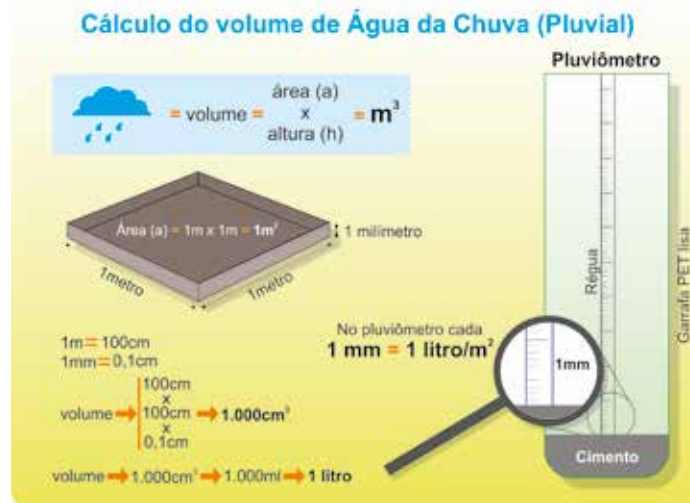
Figura 37 - Modelo adotado de pluviômetro artesanal Fonte: Adaptado de CÁLCULO (2015).
