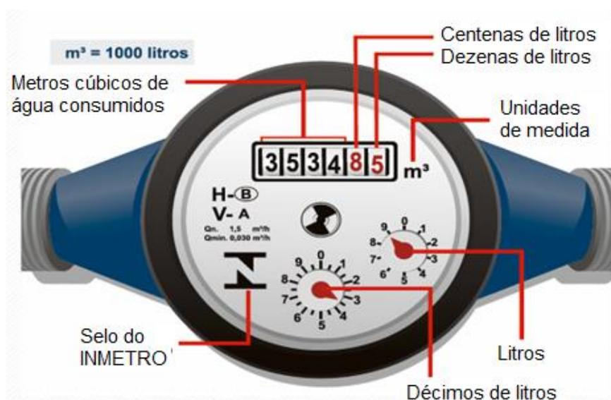
**Figura 2 – A leitura de consumo é baseada nos números pretos do visor do hidrômetro.**
