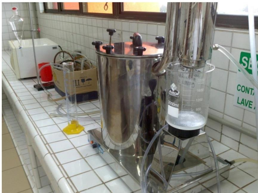
**Figura 7: Aparelhagem utilizada para extração do OE**
