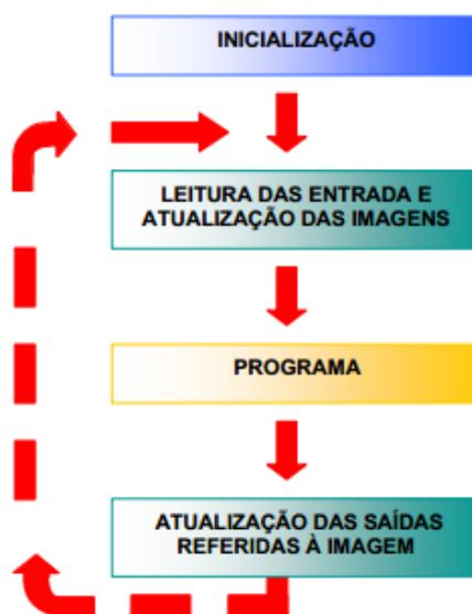
Figura 2 – Ciclo de processamento dos CLPs
