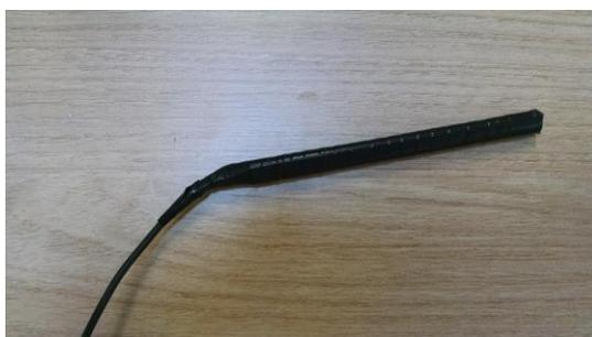
**Figura 20 - Sensor de temperatura LM35DZ**
