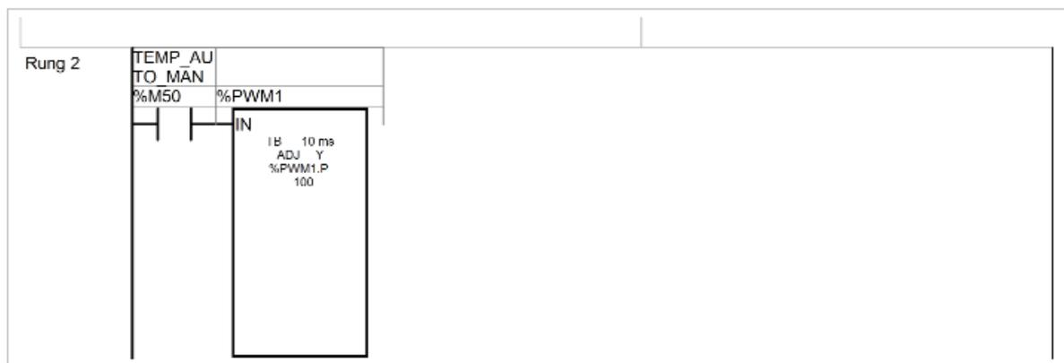
**Figura 33 - Linha de comando do acionamento do PWM**
