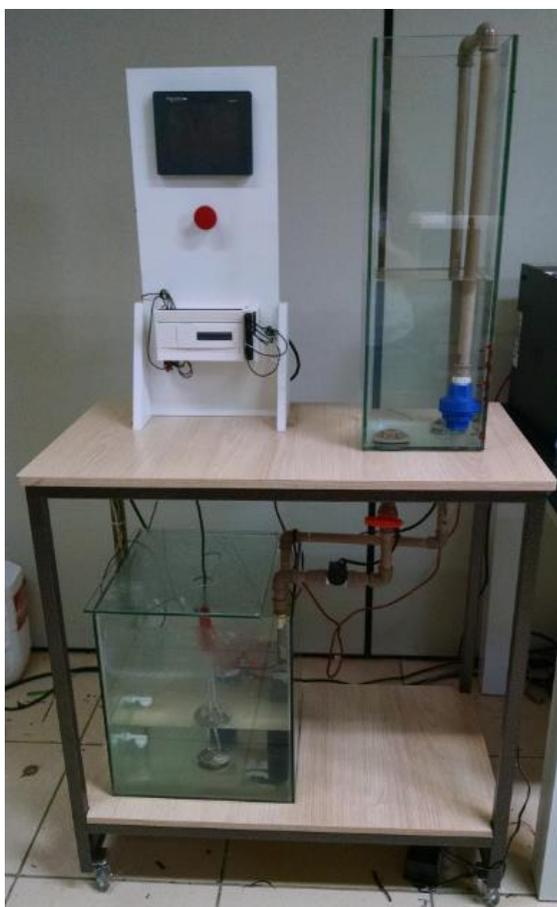
**Figura 9 - Bancada didática para controle de nível e temperatura**
