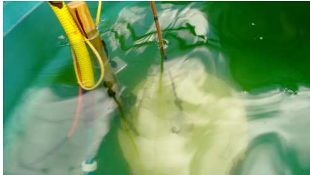
Figura 29: Visualização do disco de Secchi superior a 30 cm.
