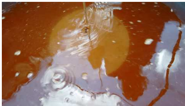
Figura 30: Visualização do disco de Secchi igual a 30 cm.
