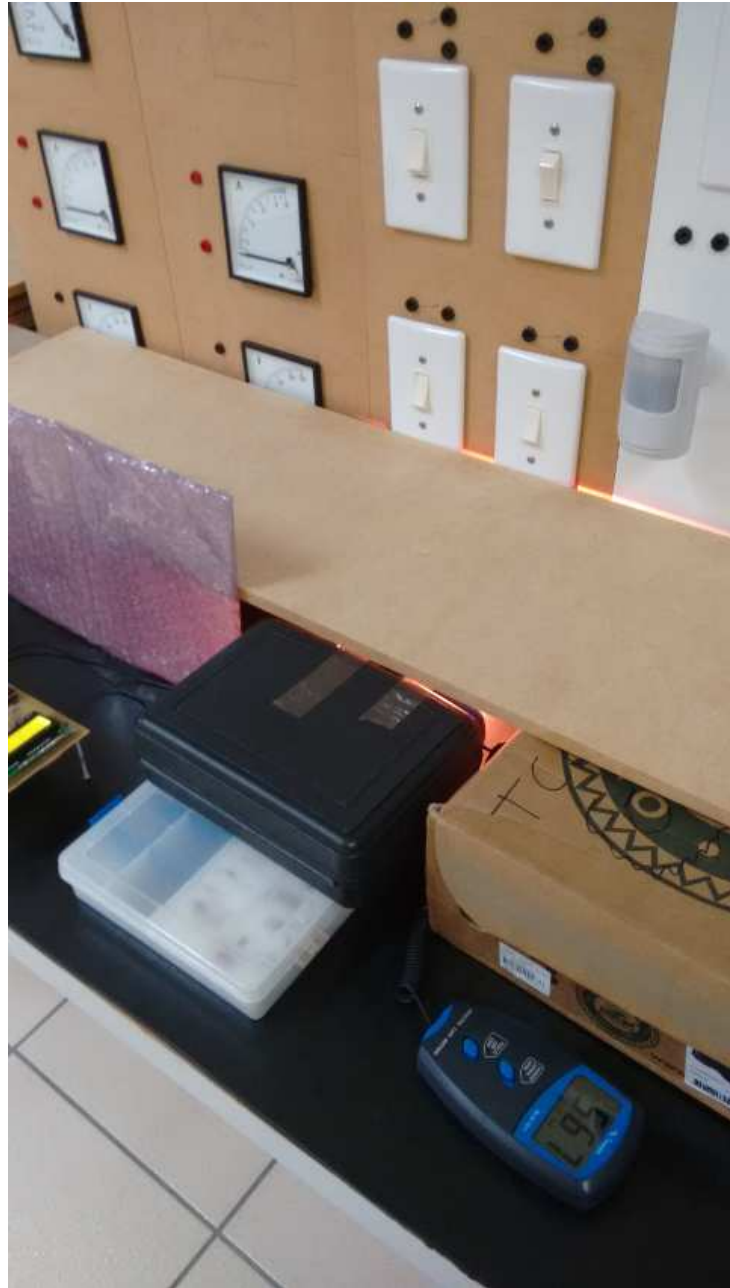
Figura 46: Estrutura para calibração do sensor de luminosidade
