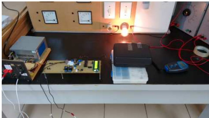
Figura 45: Estrutura para calibração do sensor de luminosidade
