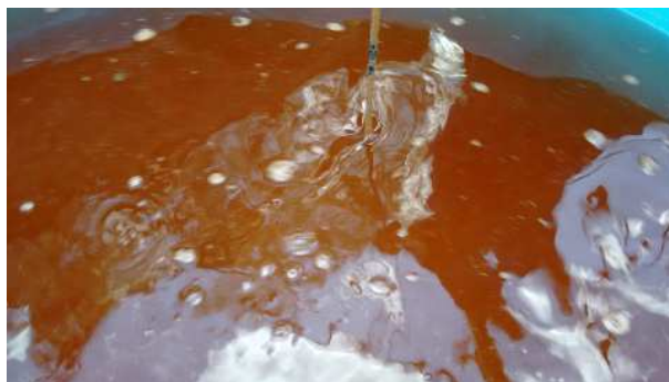
Figura 31: Visualização do disco de Secchi inferior a 30 cm.
