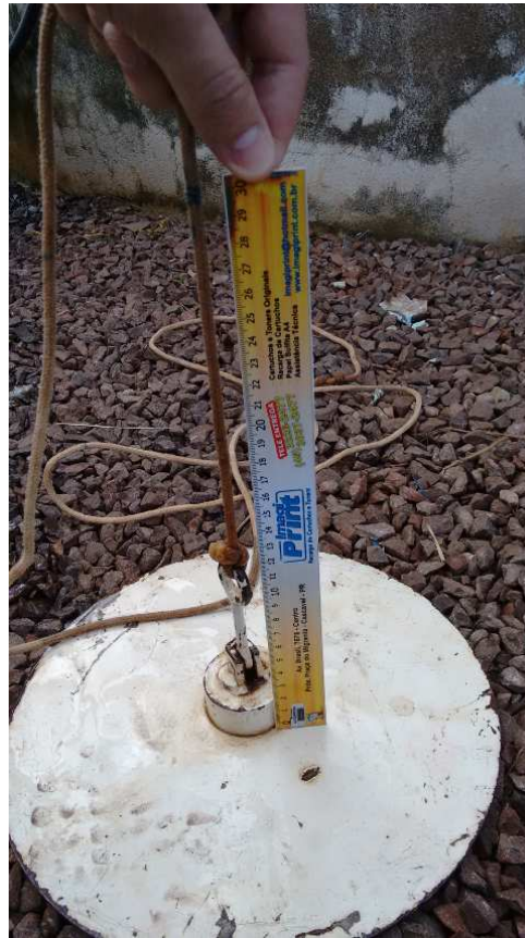
Figura 27: Profundidade do disco de Secchi
