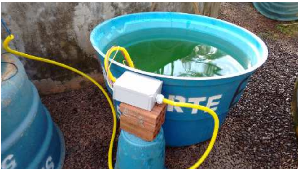
Figura 26: Calibração do sensor de turbidez
