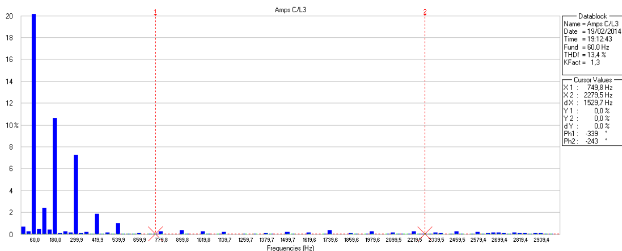
Figura 63 - Espectro harmônico da corrente da fase C/L3 do QD do pavimento térreo do bloco A. Dia 19/02/2014 às 19:12:43. Fonte: Autoria Própria
