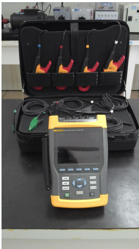
Figura 15 – Analisador de qualidade de energia FLUKE ® 434. Fonte: Própria
