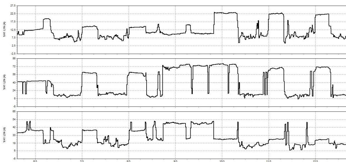
Figura 129 - Distorção harmônica da corrente, QD do primeiro pavimento do bloco A, 05/03 a 12/03/2014. Fonte: Autoria Própria
