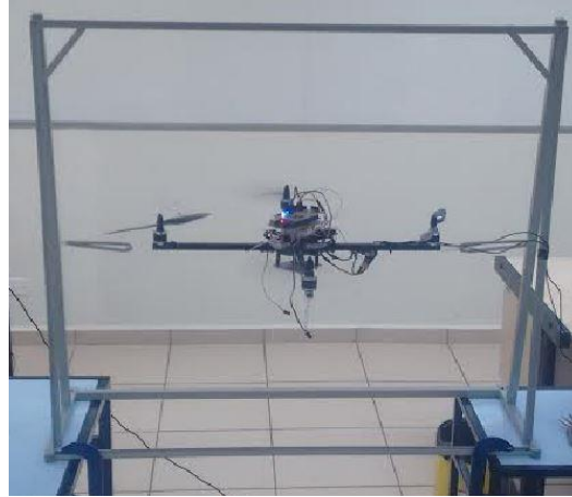
Figura 94: Estrutura com um grau de liberdade.
