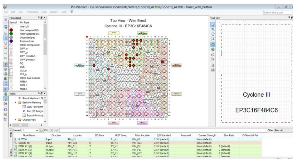
Figura 6 - Pin planner: disposição dos pinos no dispositivo (encapsulamento BGA)
