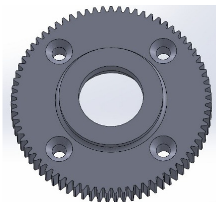
Figura 17. Projeto da engrenagem de fixação na mesa.
