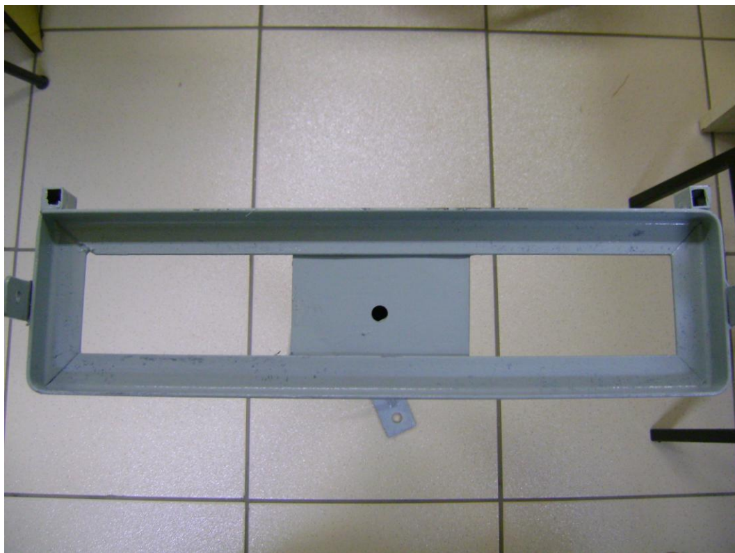
Fotografia 18 – Topo da estrutura de sustentação da caldeira. Fonte: Autoria própria.
