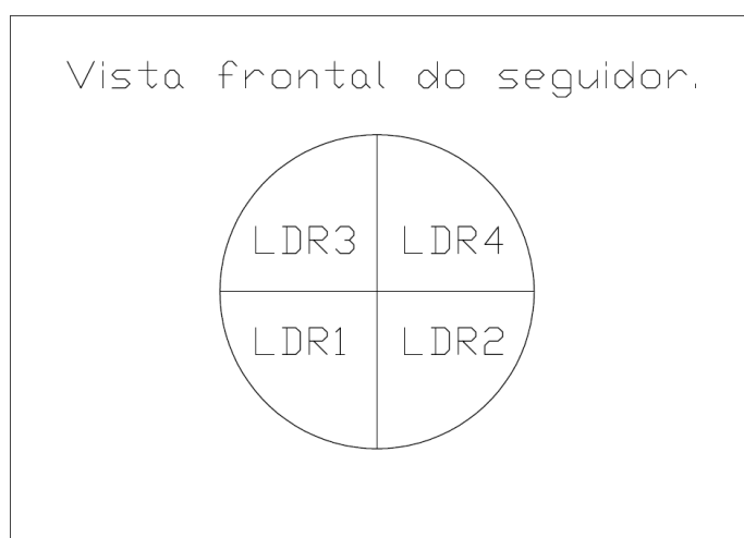
Figura 27 – Posição dos LDRs no seguidor solar. Fonte: Autoria própria.
