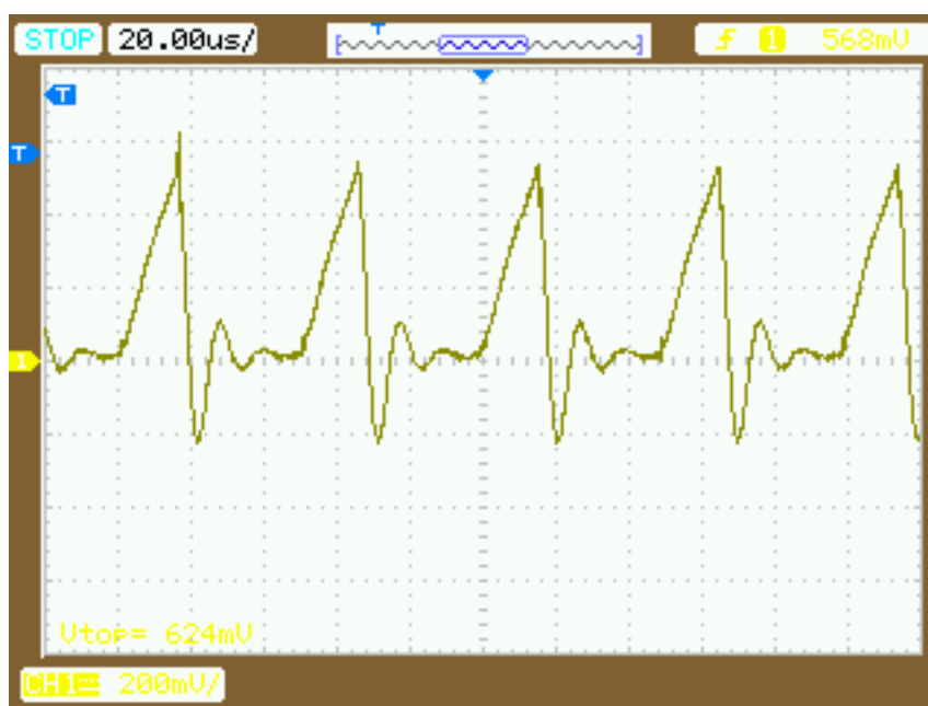
Figura 90 - Forma de onda da corrente de entrada do conversor Flyback
