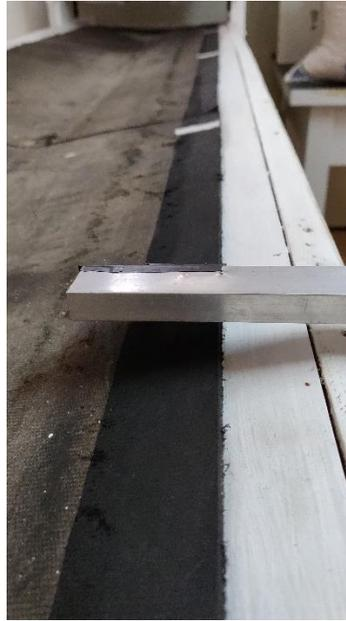
Figura 15. Sensor fixado sobre a fita e marcações brancas ao fundo.
