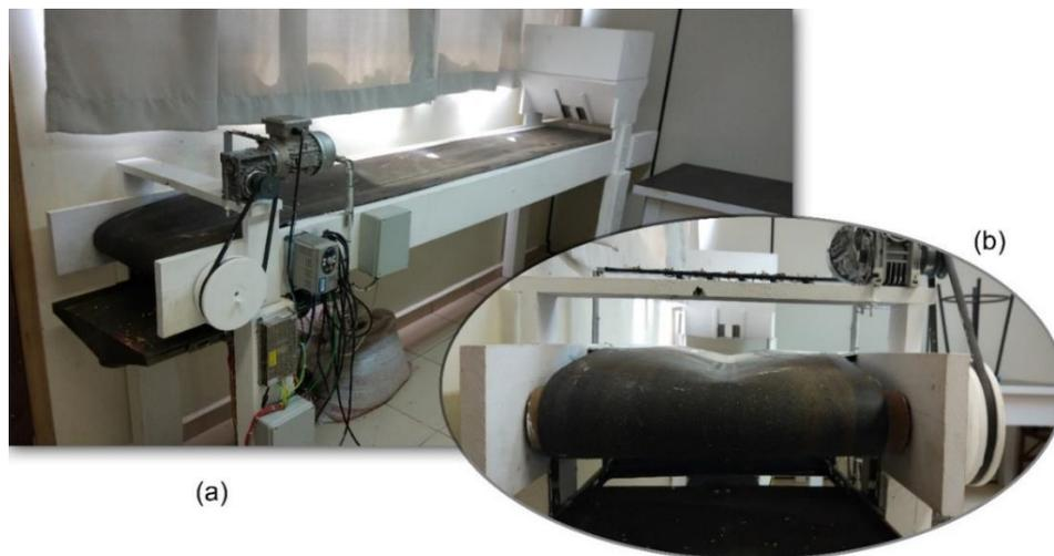
Figura 12. Protótipo de fita transportadora. (a) Visão geral. (b) Perfil da fita.
