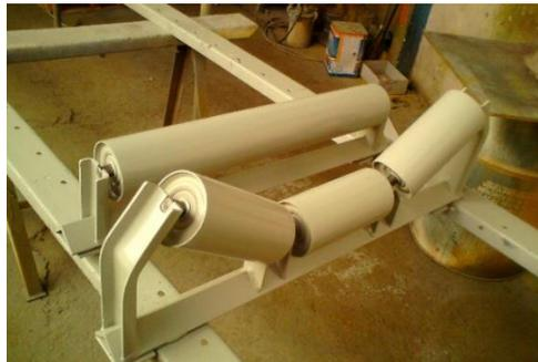
Figura 5. Roletes de carga vertical e triplo.
