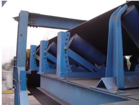
Figura 8. Roletes de transição que permitem o ajuste do ângulo da fita.
