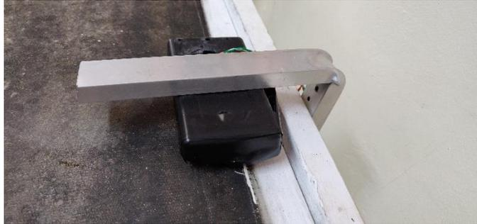
Figura 19. Sensor óptico posicionado em contato direto com a fita.
