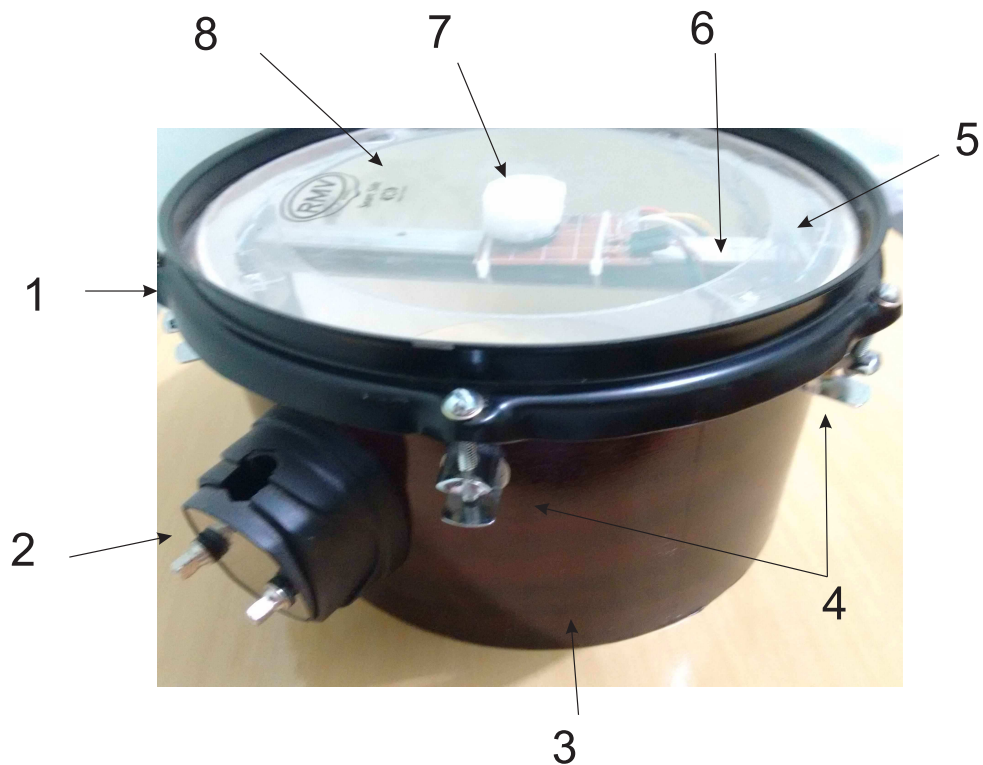
Figura 16: Visão lateral do pad dos tambores.
