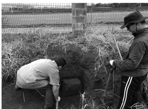
(a) - Retirada do bloco indeformado de solo.
