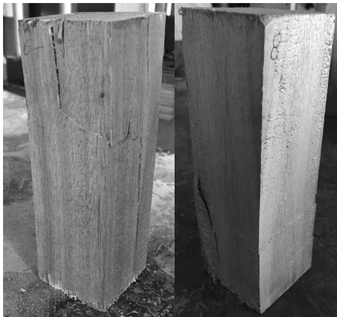
Figura 15 – Corpo de prova 6 tratado e 8 natural após ensaio de compressão paralela às fibras.
