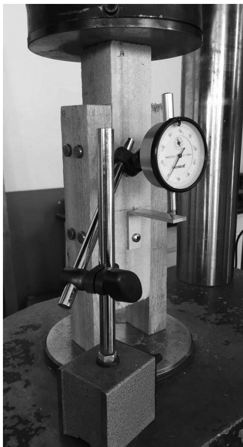
Figura 14 – Instrumentação dos corpos de prova.
