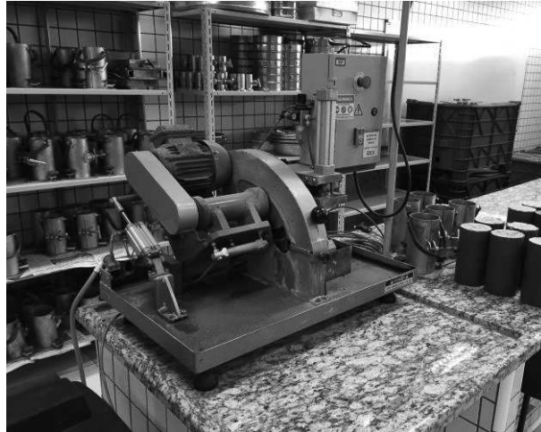
Figura 6 – Equipamento utilizado para retificação das bases dos corpos de prova
