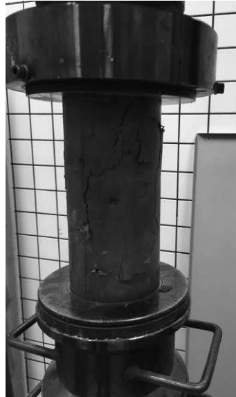
Figura 15 – Corpo de prova após realização do ensaio de compressão uniaxial.
