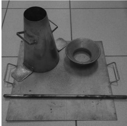
Figura 12 – Equipamentos para a realização do Slump test
