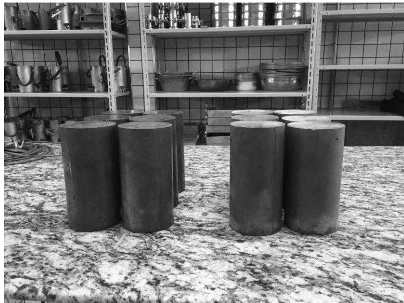
Figura 14 – Corpos de prova desmoldados.
