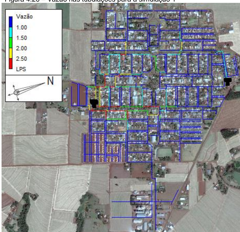
Figura 4.20 – Vazão nas tubulações para a simulação 1
