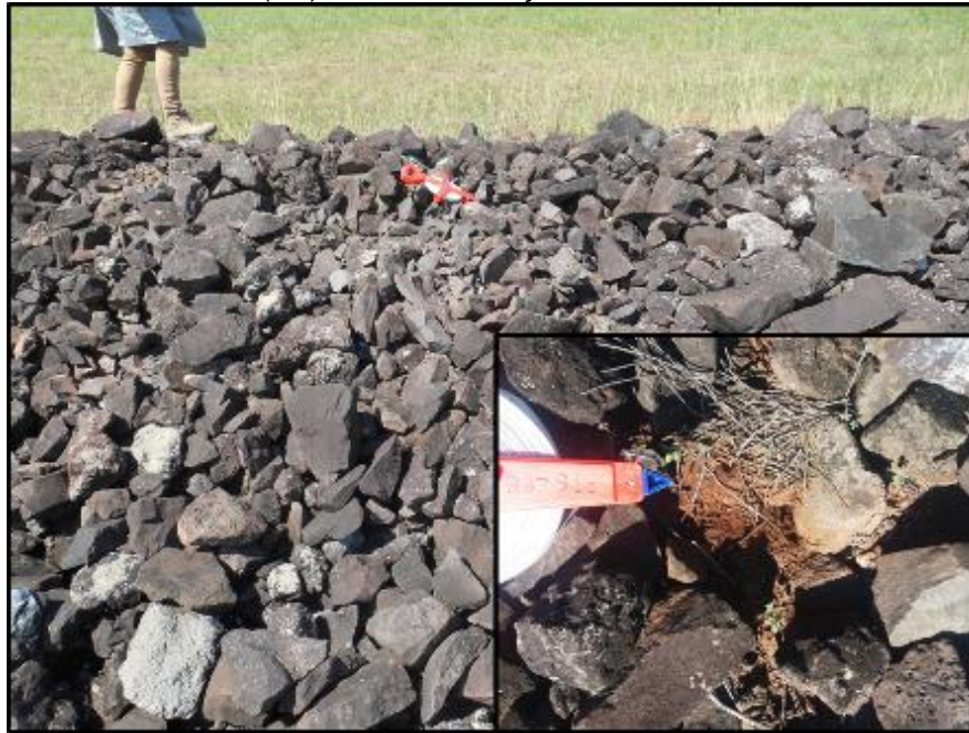
Figura 14 - Exemplo de exposição de material fino sob os blocos de rocha (G2). Área de alteração na Estaca 127+20.
