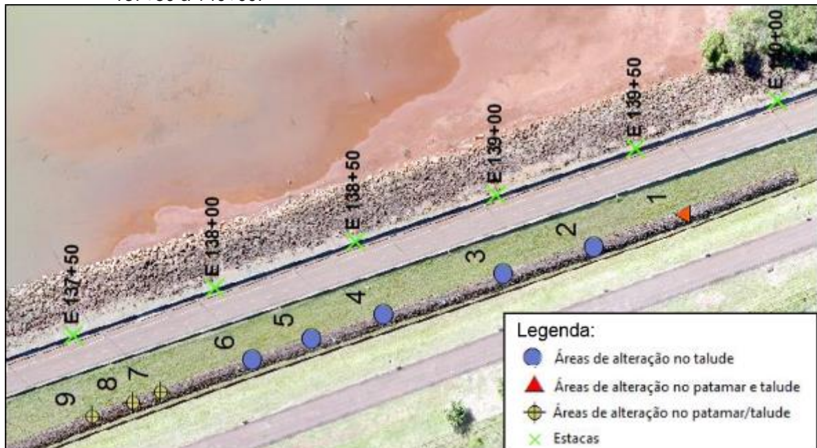
Figura 18 – Áreas de alteração no final do dreno de pé, próximo à ombreira esquerda - Estacas 137+50 a 140+00.
