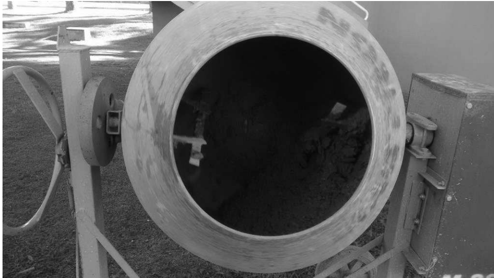
Figura 20 - Concreto convencional na betoneira Fonte: A autora (2017).
