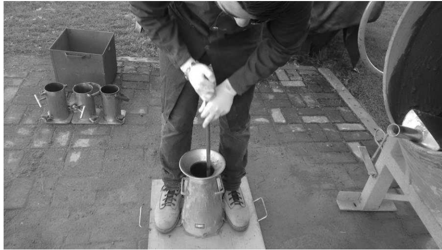
Figura 22 - Execução do ensaio de abatimento do concreto Fonte: A autora (2017).
