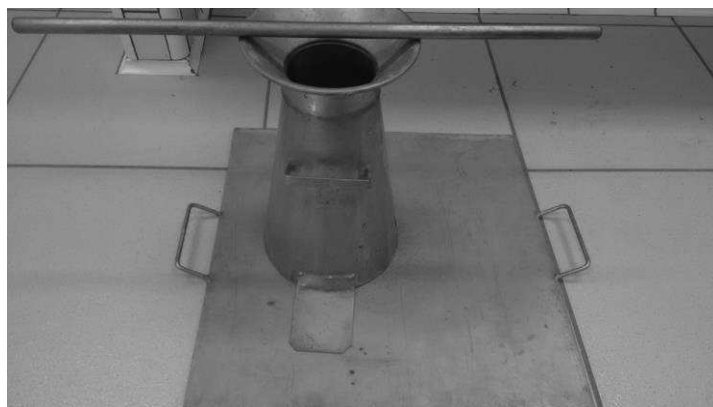
Figura 21 - Tronco de Cone para Slump Test Fonte: A autora (2017).
