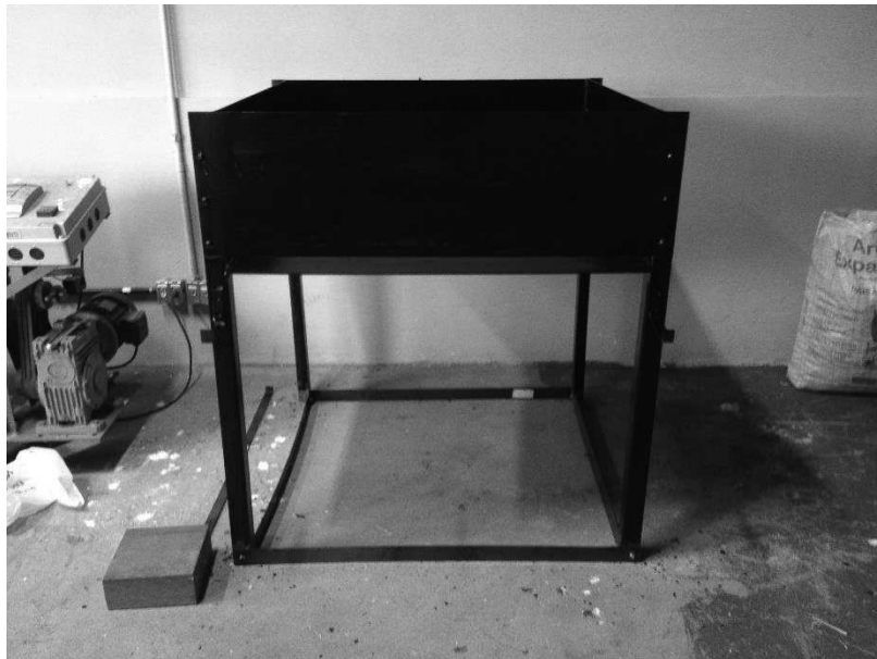
Figura 15: Protótipo após a conclusão da pintura com emulsão asfáltica. Fonte: Autor (2016).
