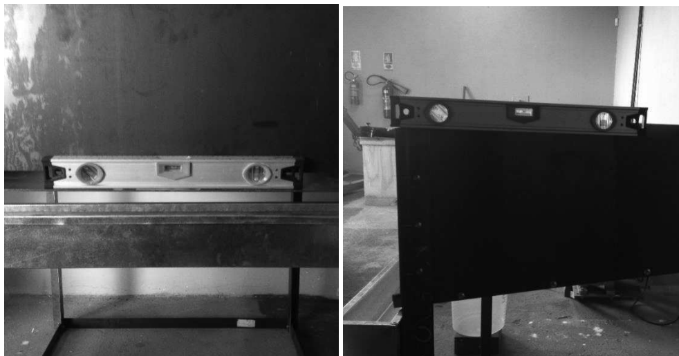
Figura 17: Verificação do nivelamento do protótipo. Fonte: Autor (2016).
