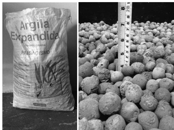
Figura 20: Verificação da espessura da camada da argila expandida. Fonte: Autor (2016).
