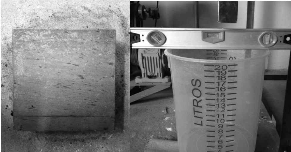
Figura 18: Nivelamento do balde graduado para leitura de vazão. Fonte: Autor (2016).
