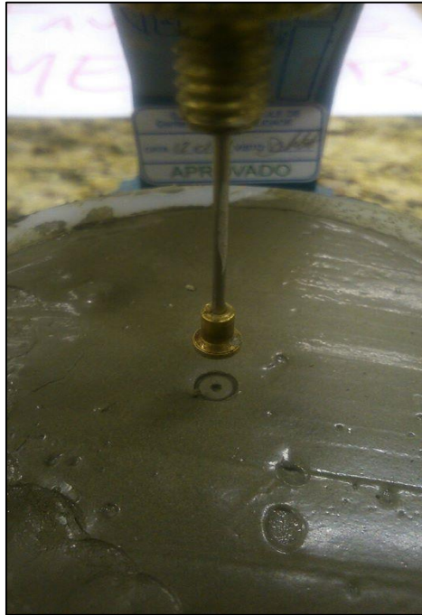
Figura 25 – Ensaio de final de pega Fonte: Autoria própria.
