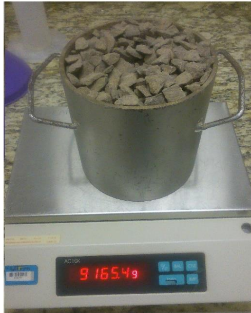
Figura 16 – Pesagem da massa total do agregado graúdo com o recipiente Fonte: Autoria própria.
