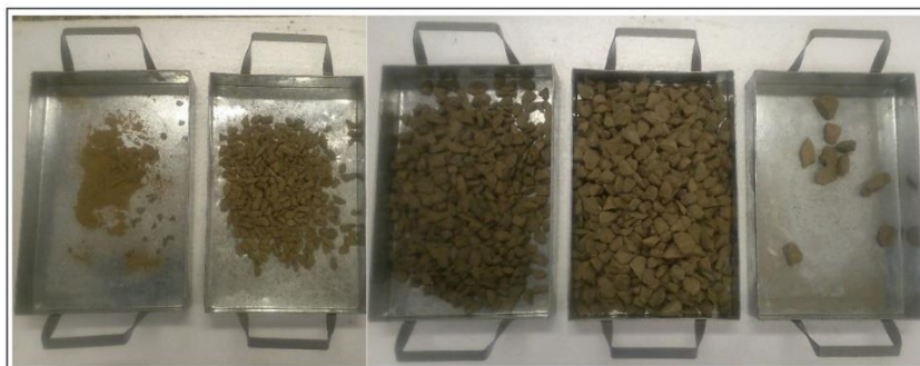
Figura 8 – Material retido nas peneiras: brita
