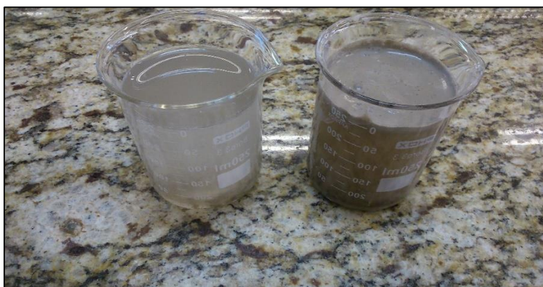
Figura 12 – Comparação da água do RCD na primeira lavagem (à direita), e após ela se tornar límpida (à esquerda)
