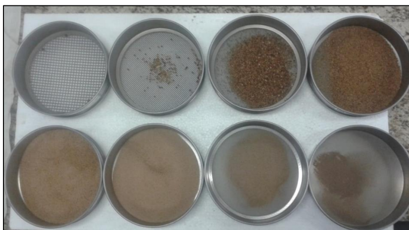
Figura 7 – Material retido nas peneiras: areia natural
