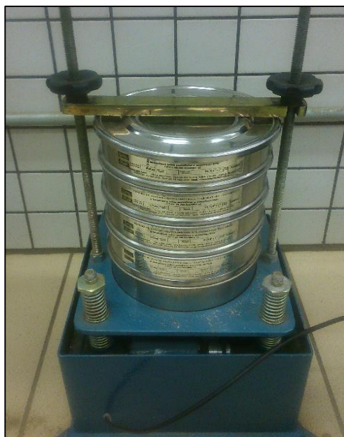
Figura 6 – Conjunto de peneiras: ensaio de granulometria
