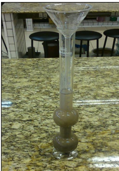
Figura 14 – Frasco de Chapman utilizado para o ensaio com o RCPC Fonte: Autoria própria.
