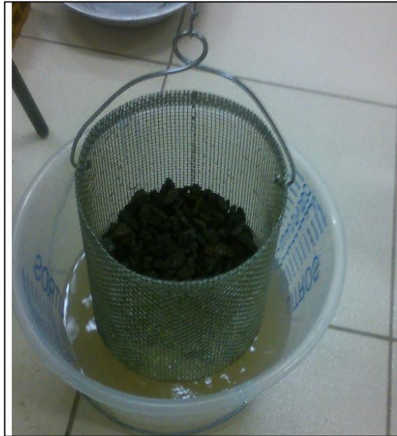
Figura 18 – Amostra do agregado graúdo submerso em água Fonte: Autoria própria.
