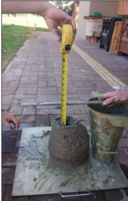
Figura 29 – Determinação do abatimento do concreto, através do “Slump Test”. Fonte: Autoria própria.
