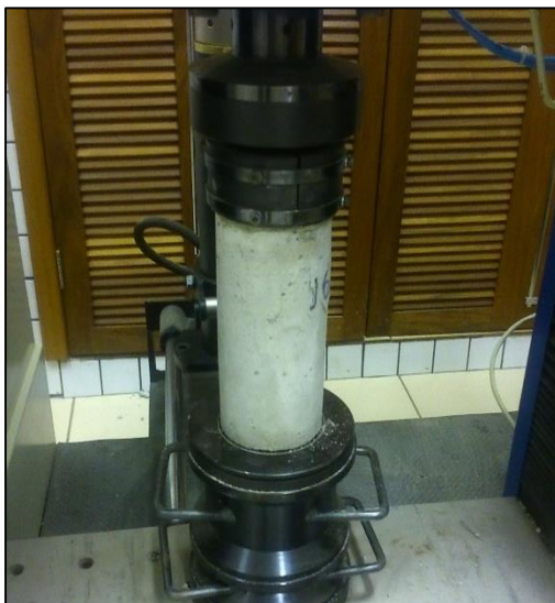
Figura 31 – Realização do ensaio de compressão axial simples.
