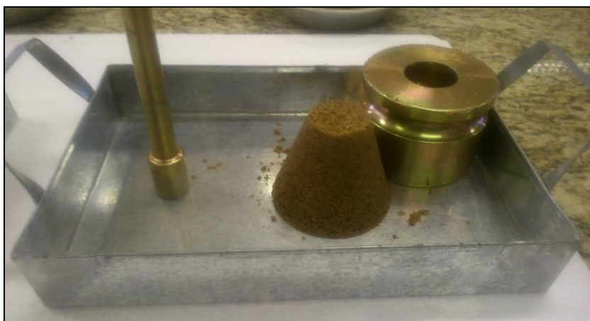
Figura 19 – Areia natural que manteve a mesma forma que o molde Fonte: Autoria própria.
