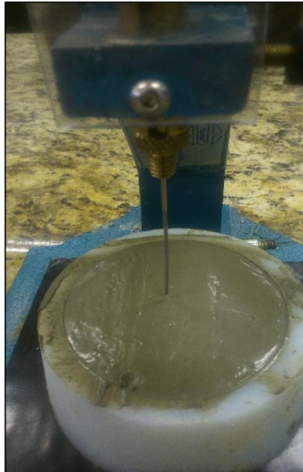
Figura 24 – Realização do ensaio de início de pega Fonte: Autoria própria.
