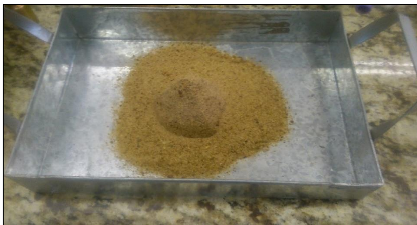
Figura 20 – Areia natural após a retirada do molde Fonte: Autoria própria.
