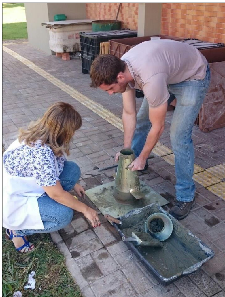
Figura 28 – Ensaio do abatimento pelo tronco de cone ( slump test ) Fonte: Autoria própria.
