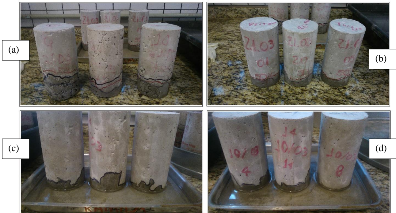
Figura 34 – Ensaio de absorção de água por capilaridade (a) e (b) Ensaios finalizados, após 72 horas (c) e (d) Ensaios em andamento, após 6 horas
