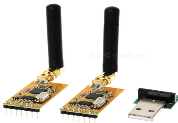
Figura 14 - Imagem da shield Módulo Rádio Wireless Apc220
