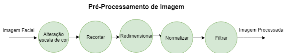
Figura 15 - Diagrama da aplicação de técnicas de pré-processamento.
