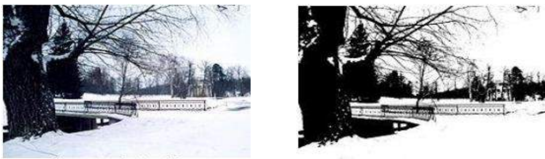
Figura 34 – Aplicação de segmentação por Thresholding , onde a esquerda está a imagem original e a direita a nova imagem a partir da segmentação.
