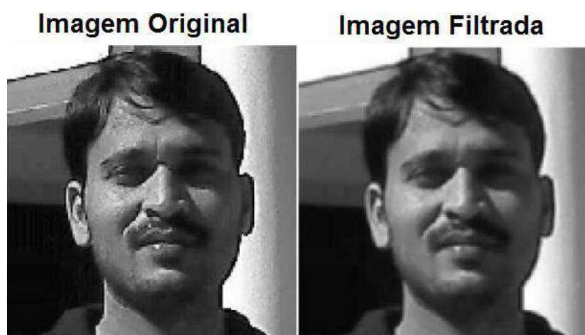
Figura 18- Filtragem de face com uso do filtro passa-baixa.
