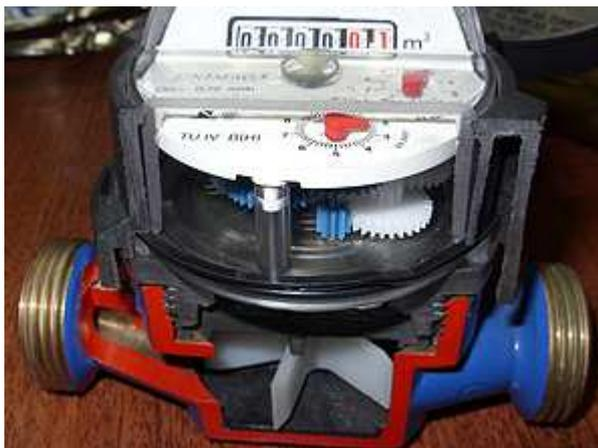
**Figura 1 – Hidrômetro (corte).**
