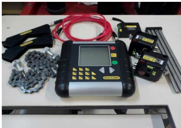
Figura 13 - Alinhador a Laser EASY-LASER D450
