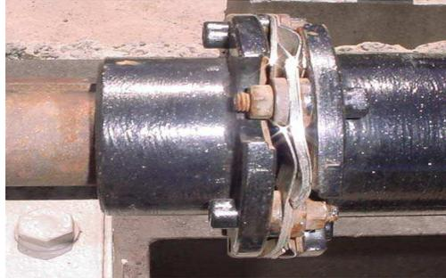
**Figura 8 – Acoplamento danificado por desalinhamento**
