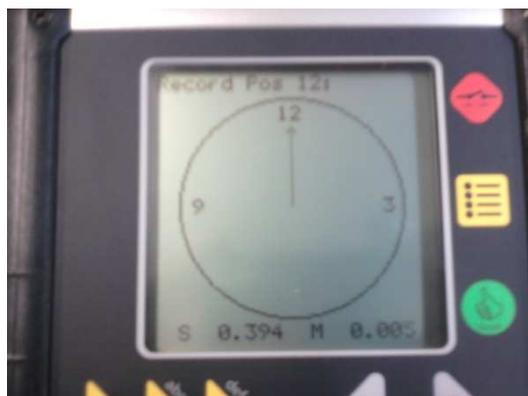
**Figura 20 - "12 horas" Posição na qual deverá ficar as Unidades de Medição "S-M" para a opção Softfoot**
