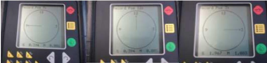
**Figura 22 - Posição nas quais deve-se girar o eixo com as Unidades de Medição "S-M"**
