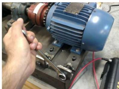
**Figura 29 - Ilustração de como simular desalinhamentos ou alinhar a bancada**
