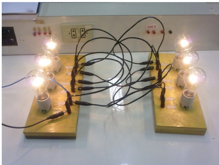
Figura 22 - Carga resistiva ensaiada.
