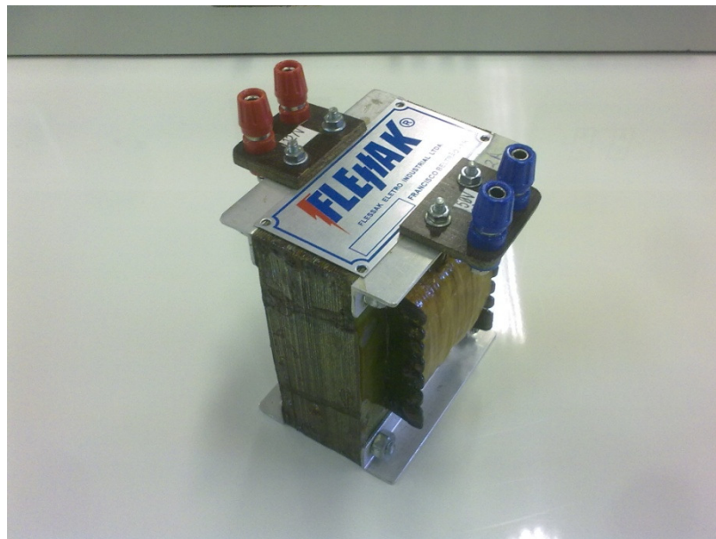
Figura 17 - Transformador comercial ensaiado.
