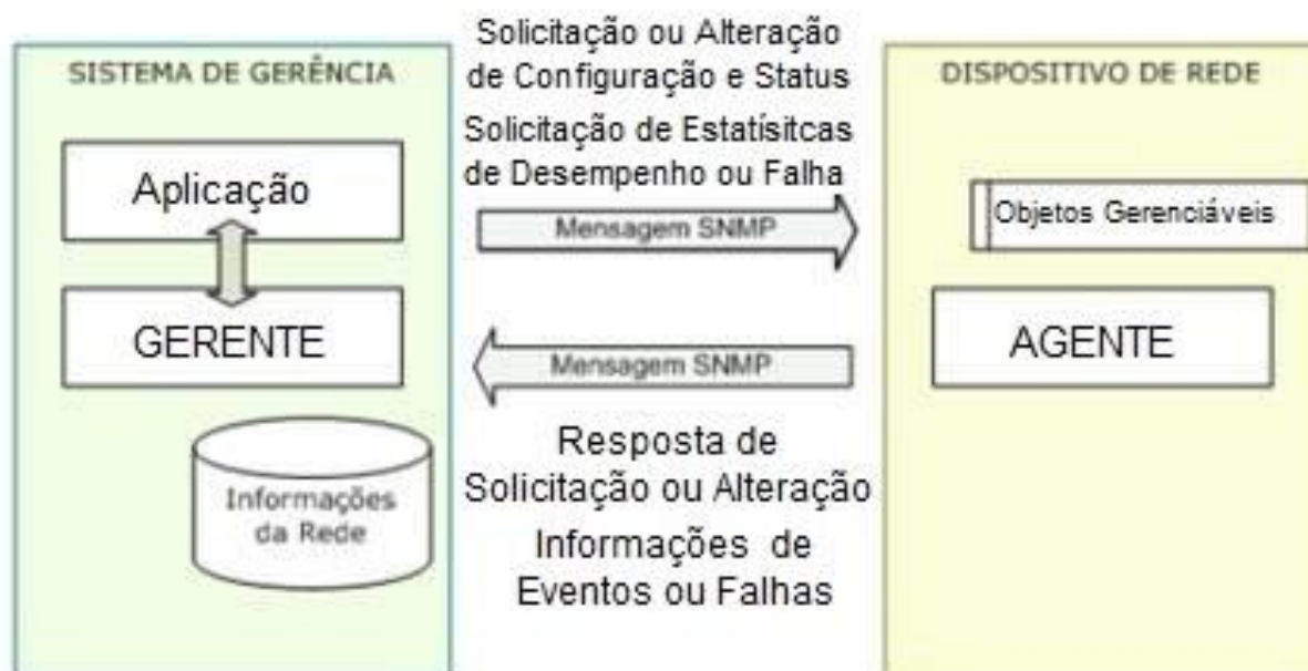
Figura 4 - Relação entre agente e gerente SNMP Fonte: Poletto (2012, p. 2). Adaptado pelo autor.
