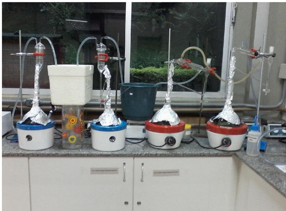
**Figura 5 – Sistema de obtenção de óleo essencial por hidrodestilação, utilizando 4 aparelhos de Clevenger.**
